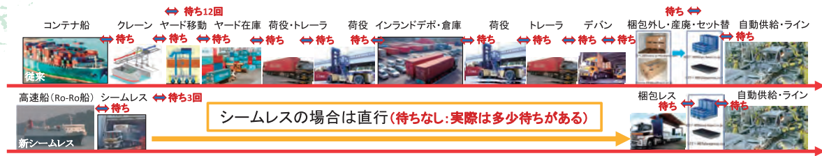
図2 シームレス物流の効果（上段：一般コンテナ船，下段：Ro-Ro 船シームレス物流）
